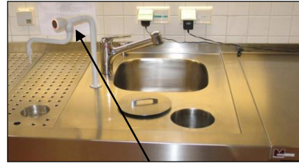
Manueller Formalin-Spender auf einer MEDIS MT-Zuschneide-Station. Darunter der Ablauf für gebrauchtes Formalin (Rücklauf in 600L-Behälter)
