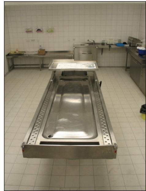
MA-2000 mit Transfer-Arbeitsfläche (Mulde)
