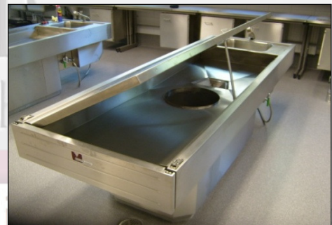
Beispiel einer sog. „Dom“-Absaugung, die wir als Sonderausführung nur einmal hergestellt haben. Der Boden ist nicht glatt und das Abluftrohr geht direkt in das Abluft-System. Abfall kann ungehindert in das Abluftsystem gelangen!
