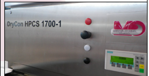
Das Foto zeigt die Siemens Programmierereinheit mit Not-Aus und Alarm-Meldung
