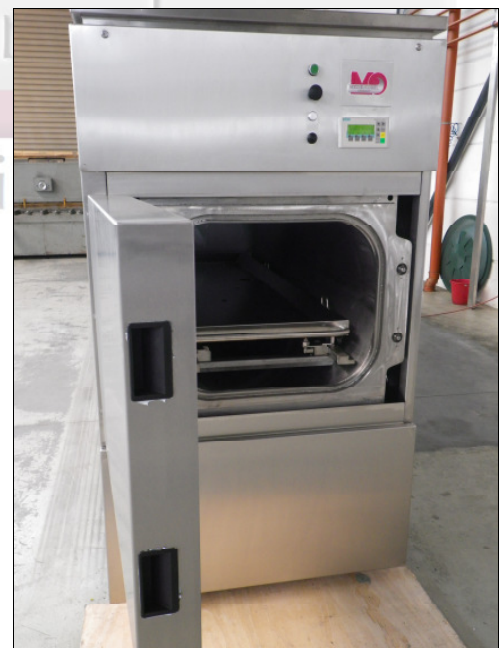
MA-1700-1 “DryCon© HPPS” Modular Unit mit Hochdruck-Prozesskammer für beste Gewebe-Infiltration
