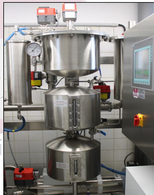
Dichlormethan-Rückgewinnungsanlage mit Kondensator und Vorratsbehälter
