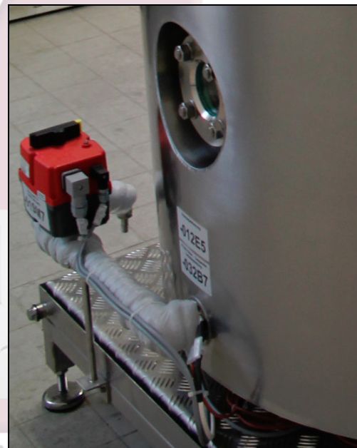
Beheizter Ausgang für Knochenfett seitlich an der Anlage. Leicht zugänglich und effektiv
