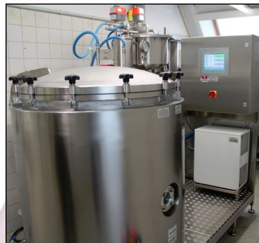
Knochenentfettungsanlage mit DCM-Rückgewinnungs- und Knochentrocknungsmodul. Entfettungskammer: 1000mm AD x 900mm(H)
