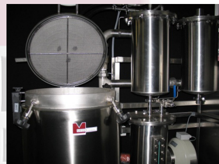
MA-1370 mit Prozesskammer und Tropfbrause DCM Vorrats- und Recycling- System (Mitte) und Trocknung/Gebläse (unten rechts)
