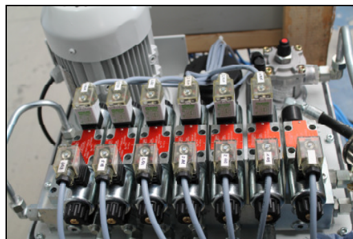
Hydraulische Kompakt-Steuereinheit für 6 Kuvetten
