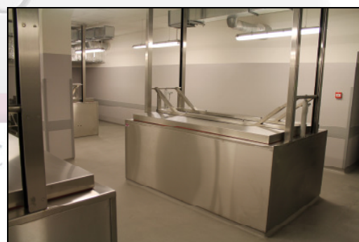
MA-1347 für 6 Körper (in Bodenvertiefung eingesetzt) in eingefahrenem Zustand
