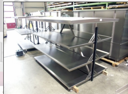
MA-1338 Küvette mit Einsatz für 6 (2 x 3) Körper. Der zugehörige Tank befindet sich im Hintergrund
