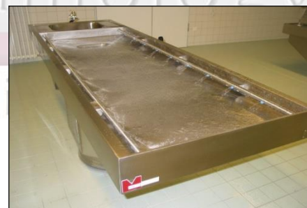
Seziertisch mit Randabsaugung und Flächenspülung
