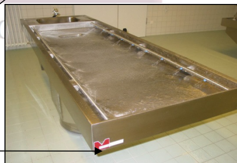
Seziertisch mit Randabsaugung und Flächenspülung.
