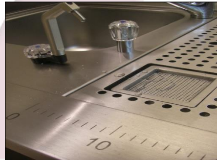
MA-0885 mit Frischformalin-Dosierung
