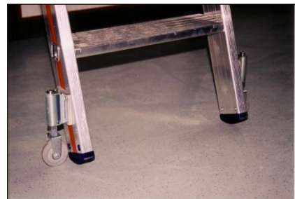
Feststell-Mechanismus der Sicherheitsleiter
